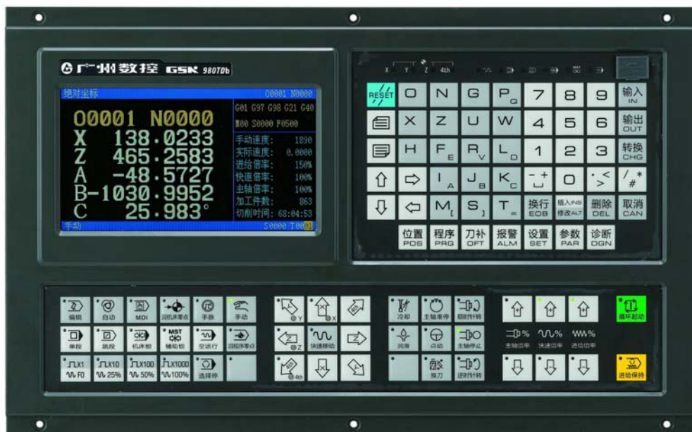
Система ЧПУ GSK TDb установлена на токарном станке
